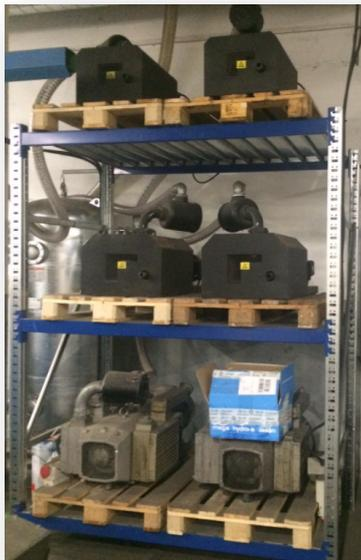
Statt bisher 6 Pumpen unkoordiniert über die internen Saugregler im Falschlufbetrieb zu fahren, wurden 4 Pumpen an ein **Airleader-MASTER-Modul** in Vakuumausführung angeschlossen. 2 Pumpen verbleiben als Reserve. Die Airleader-Steuerung und die Leistungselektrik der Pumpen fanden in einem gemeinsamen **Vakuum-Sonderschrank** platz:
